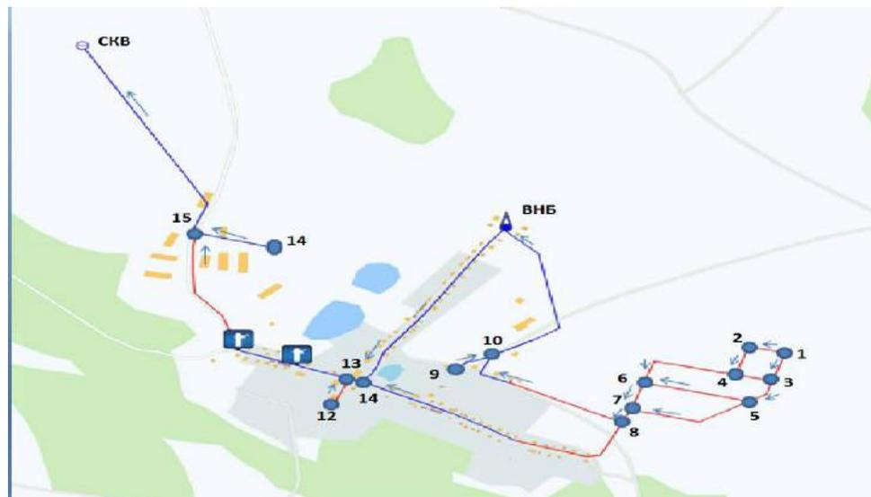
Рис. Разбивка территории д.Трошкино на участки для расчета узловых расходов
